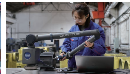
精益服務一質量檢驗人員正在使用關節臂式三坐標測量電機機座形位公差
