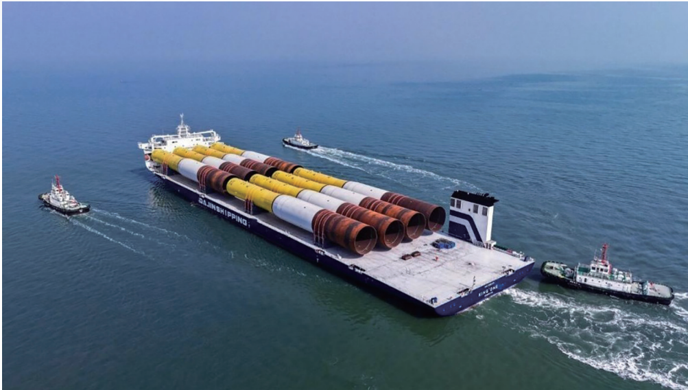
2026年5月，KING ONE輪第二個跨洋航次啟程，運輸直徑11米TP-less無過渡段風電單樁至歐洲某港口
